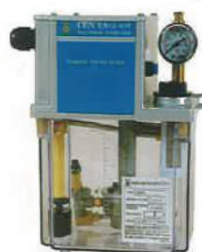
CEN01 由PLC 控制時間 CEN01 Controlled By PLC
